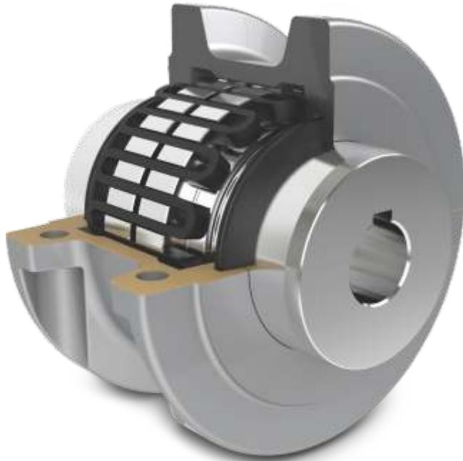
As grades do acoplamento T possuem seção trapezoidal e são fabricadas em aço ligado de alta resistência temperadas e revenidas para dureza de molas. A superfície é então jateada com micro esferas de aço com grande precisão de operação denominada de "Shot peening" que comprimem as moléculas da superfície por trabalho mecânico.
